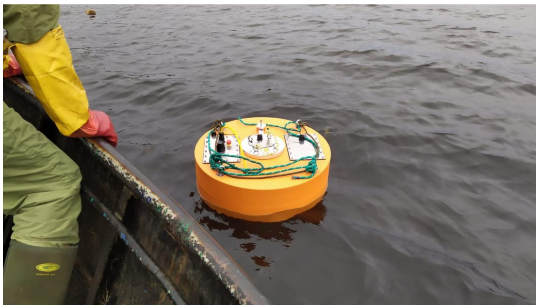
4.attēls Uzlabotā roņu atbaidīšanas ierīce “Ronis-2” ar maināmu akumulatoru (vidū). RTU publicitātes foto.
